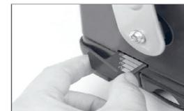
(Рис.2) Установите регулятор глубины пробивки в нужное положение
