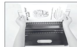
(Рис.5) Наденьте перфорированные листы и обложки на пружину.
