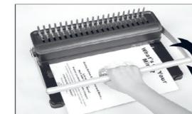
(Рис.3) Разместите листы (не более 12 шт 80 г/м<sup>2</sup>) в слоте перфорации и нажмите на ручку до окончания пробивки. Верните ручку в исходное
