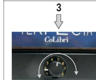
3. Для обрезки и спаивания одинарного рулона установите датчик нагрева в диапазоне 4-5 (рис.3)
