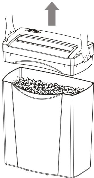
1. Снимите режущий блок
